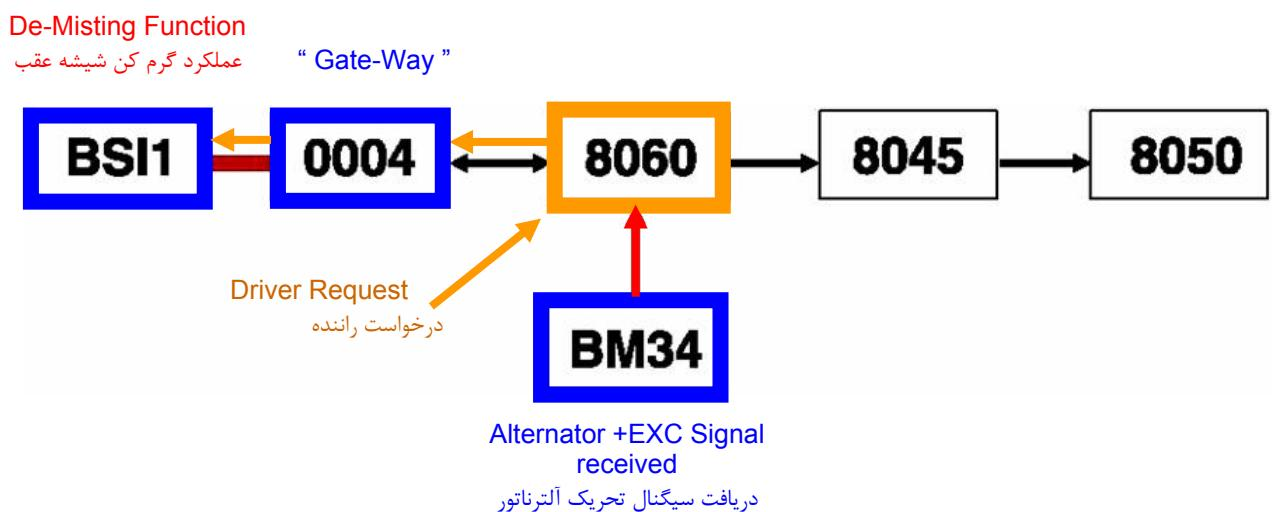
در صورت وجود سیگنال تحریک آلترناتور و درخواست راننده مبنی بر فعال شدن گرم کن شیشه عقب ، کنترل یونیت گرمایش - تهویه در خواست راننده را از طریق پشت آمپر به BSI منتقل می نماید و BSI گرم کن را فعال نموده و عملکرد آن را کنترل می نماید .
