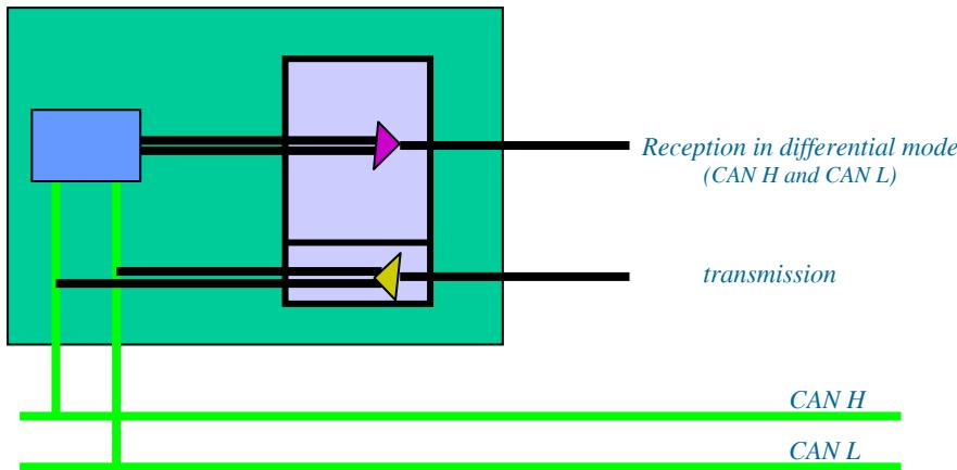
همانطور که مشاهده می شود درصورتیکه یکی از خطوط CANH و یا CANL حاوی اطلاعات نباشند و یا اطلاعاتشان به نوعی دستکاری شده باشد به دلیل ساختار Line Interface ، اطلاعات خط دیگر نیز قابل انتقال نخواهد بود .
