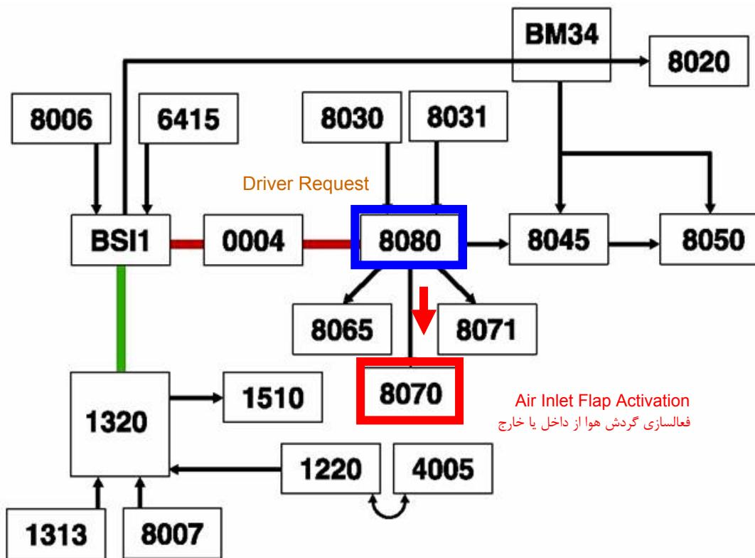
در حالت تنظیم دمای اتوماتیک ، راننده می تواند گردش هوا از داخل یا خارج از اتاق سرنشین را با استفاده از دگمه مربوطه مطابق دلخواه خود تغییر دهد.
