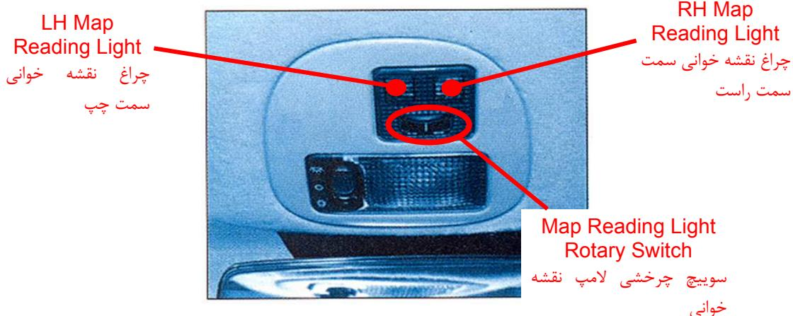
جهت روشن کردن چراغ سقفی در حالت دستی ضرورت دارد که سیگنال AA+ وجود داشته باشد و در حالت اتوماتیک با باز و بسته کردن دربهای خودرو خاموش و روشن می شود. همچنین چراغ نقشه خوانی را می توان به صورت جداگانه با وجود سیگنال AA+ فعال نمود.
