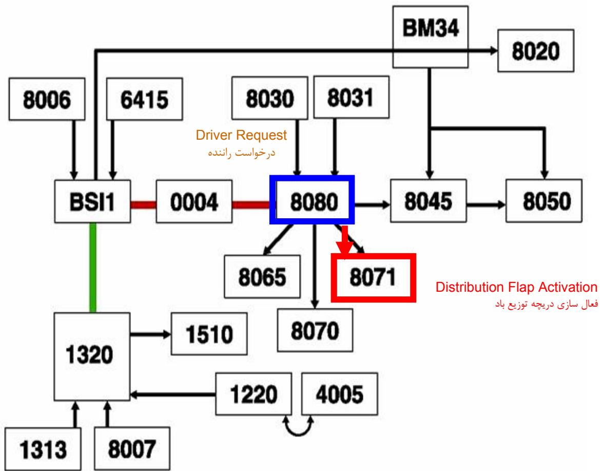
در حالت تنظیم دمای اتوماتیک ، راننده می تواند نحوه توزیع باد را با استفاده از دگمه ه مربوطه موجود روی پنل ، مطابق دلخواه خود تغییر دهد .
