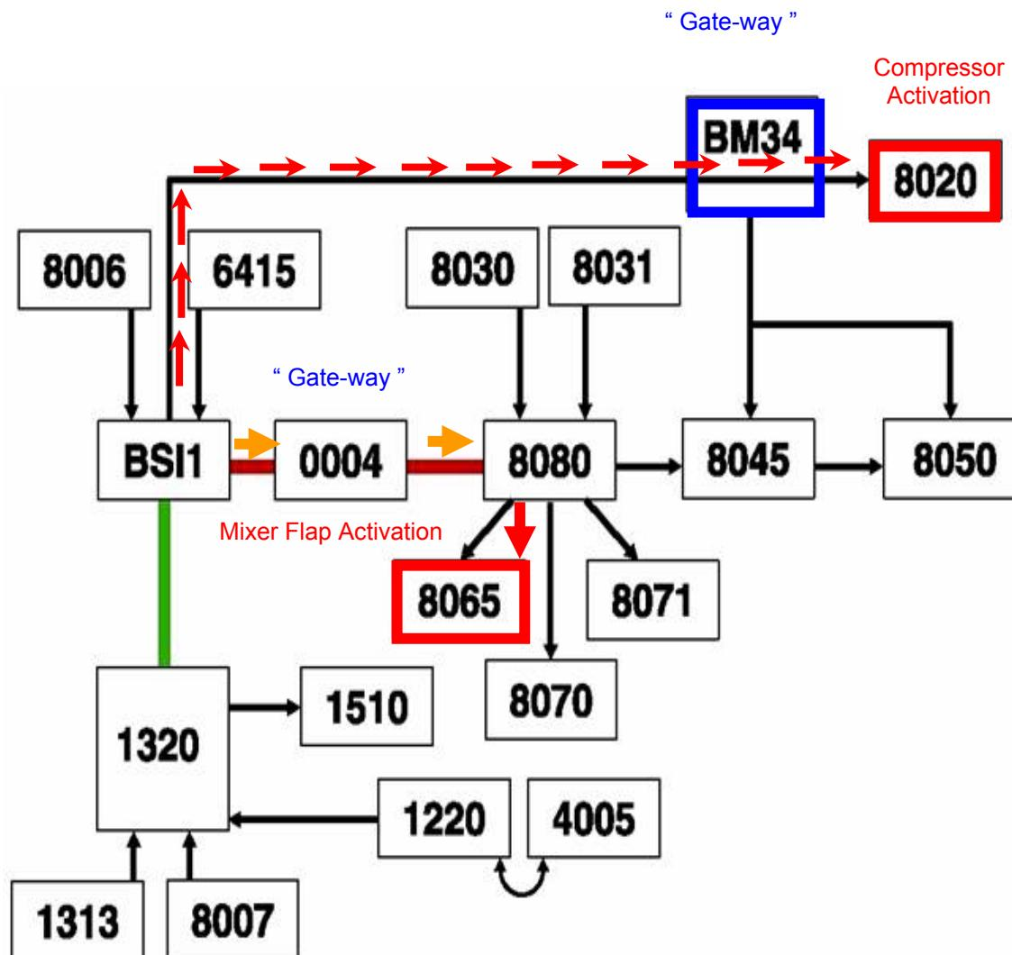
پس از فعال شدن کمپرسور کولر ، کنترل یونیت کولر اتوماتیک با دریافت اطلاعات دمای هوای داخل و خارج اتاق سرنشین با تغییر دریچه مخلوط کننده ، میزان گرمی و سردی(حاصل از فعالیت کمپرسور) را طوری تنظیم می نماید تا دمای مطلوب را حاصل گردد .
