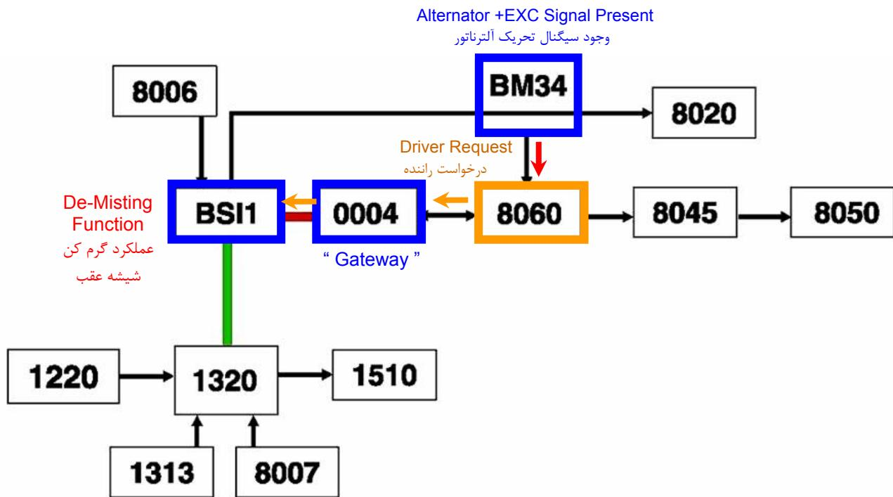
در صورت وجود سیگنال تحریک آلترناتور و درخواست راننده مبینی بر فعال شدن گرم کن شیشه عقب ، کنترل یونیت بخاری- کولر در خواست راننده را از طریق پشت آمپر به منتقل می نماید و BSI گرم کن را فعال نموده و عملکرد آن را کنترل می نماید .
