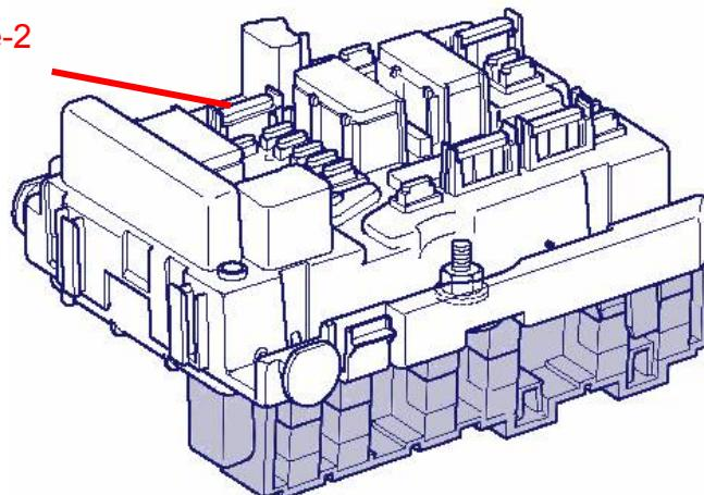
با استفاده از سیگنال ECU موتور(۱۳۲۰)، مدول ۲ جعبه فیوز BM34 تجهیزات زیر را تغذیه می نماید. (شبیه عملکرد رله دوبل انژکتور) :
