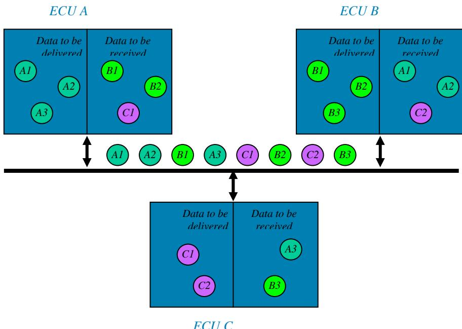
در سیستم مولتی پلکس نیز انتقال اطلاعات بین کنترل یونیتهای مختلف به صورت سری صورت می پذیرد . که به این منظور از دو رشته به هم تابیده شده کواکسیال با سطح مقطع ۶.۰ میلی متر مربع استفاده شده است .
