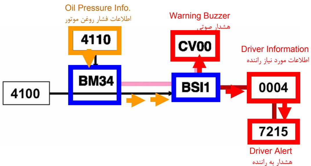
اطلاعات فشار روغن موتور از طریق سنسور مربوطه در اختیار BM34 قرار می گیرد و BM34 از طریق شبکه VAN این اطلاعات را در اختیار BSI قرار داده تا جهت نمایش بر روی پشت آمپر ارسال نموده و در صورت نیاز فرمان فعل شدن آلارمهای صوتی و دیداری را از طریق شبکه مولتی پلکس و قطعات نمایشگر چند منظوره و COM2000 صادر نماید .
