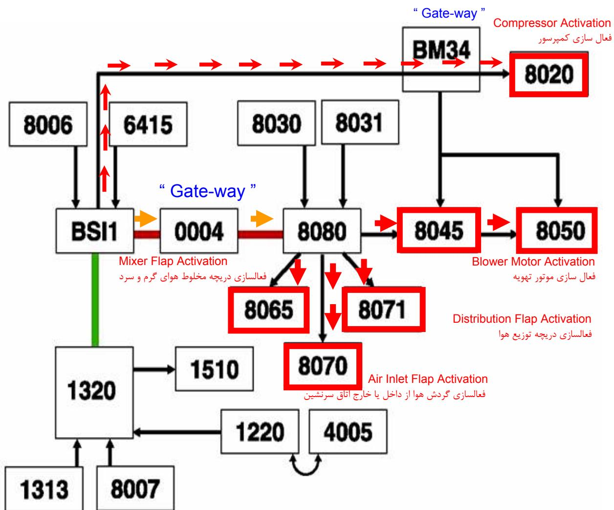
در صورت تنظیم دما و قرار دادن سیستم در حالت برنامه "کولر اتوماتیک" ، کنترل یونیت کولر اتوماتیک تنظیمات مربوط به گردش هوا از داخل یا خارج ، نحوه توزیع باد، میزان مخلوط هوا گرم و سرد با استفاده از کمپرسور یا عدم استفاده از کمپرسور و سرعت فن تهویه را به صورت اتوماتیک انجام داده تا به دمای مطلوب و درخواستی رانده برسد .
