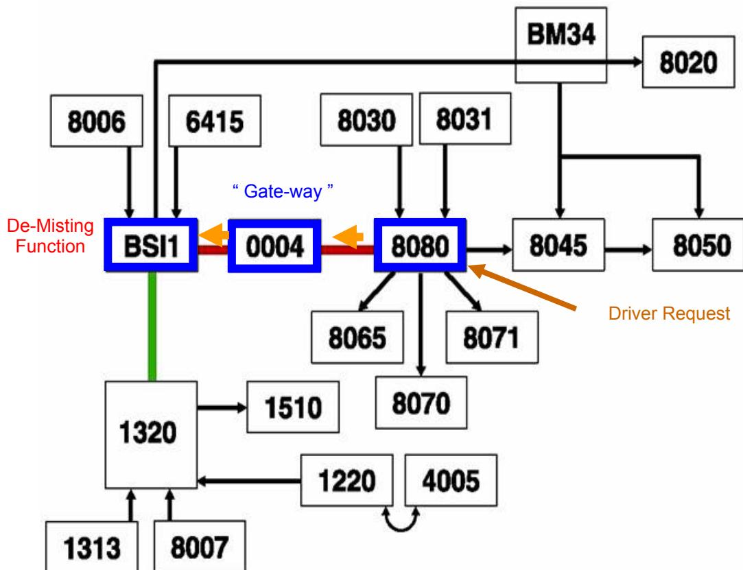
در حالت دستی ، راننده می تواند با فشردن دگمه گرم کن شیشه عقب ، درخواست خود را ارسال نماید . این درخواست در اختیار پشت آمپر قرار میگیرد تا از طریق شبکه VAN به BSI منتقل گردد و BSI ، گرم کن شیشه عقب را فعال نموده و عملکرد آن را تحت کنترل قرار دهد .
