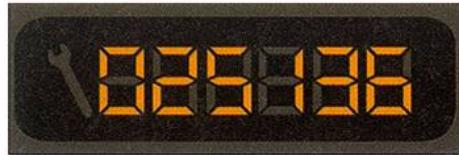
با فشردن دگمه ریست حالت نمایشگر کل کیلومتر به نمایشگر مسافت طی شده تغییر می یابد . در این حالت اگر دگمه ریست را فشرده نگه دارید(بیشتر از ۳ ثانیه) مقدار مسافت طی شده صفر می گردد ، البته در نظر داشته باشید که فقط تا ۱۰۰۰ کیلومتر در این حالت قابل نمایش است و پس از پیمايش ۱۰۰۰ کیلومتر مقدار مسافت نشان داده شده به صورت اتوماتیک صفر می گردد (در این حالت) .
