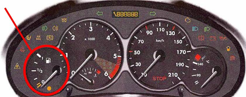
نمایشگر میزان سوخت و لامپ اخطار( LED ) مربوط به پایین بودن سطح سوخت هر دو در پشت آمپر قرار گرفته اند . در واقع **BSI** اطلاعات مربوط به سوخت را به صورت رشته سیم مستقیم از مجموعه پمپ بنزین
