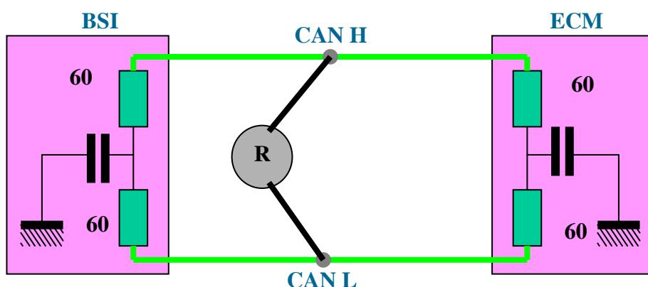
همانطور که مشاهده می کنید در هر ترمینال دو مقاومت ۶۰ اهم به صورت سری قرار گرفته اند. بنا بر این در صورت جدا نمودن کانکتورهای مربوط به کنترل یونیت موتور و BSI که خطوط شبکه روی آن قرار گرفته اند ،
