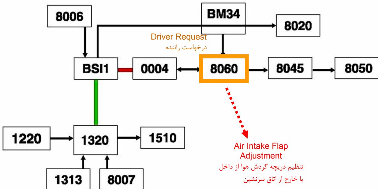
راننده با تغییر وضعیت کلید مربوطه موجود روی پنل کولر- بخاری ، به صورت مکانیکی موقعیت دریچه گردش هوا از داخل و یا خارج از اتاق سرنشین را تعیین می نماید .
