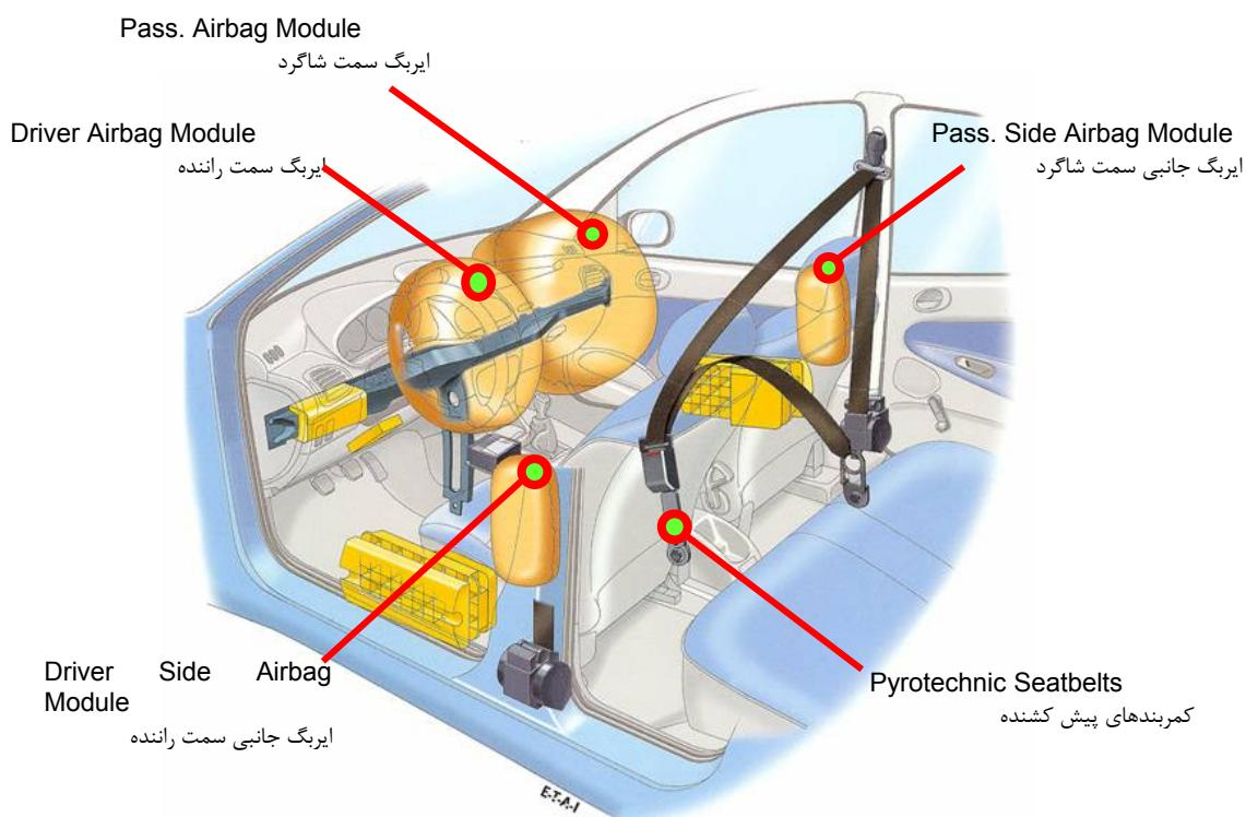
سیستم کمربندهای ایمنی پیش کشنده و ایربگ دارای یک کنترل یونیت واحد می باشد که جهت فعل کردن هر دو سیستم از آن استفاده می گردد . این کنترل یونیت جلوی دسته دنده وسط کنسول خودرو قرار گرفته است .
