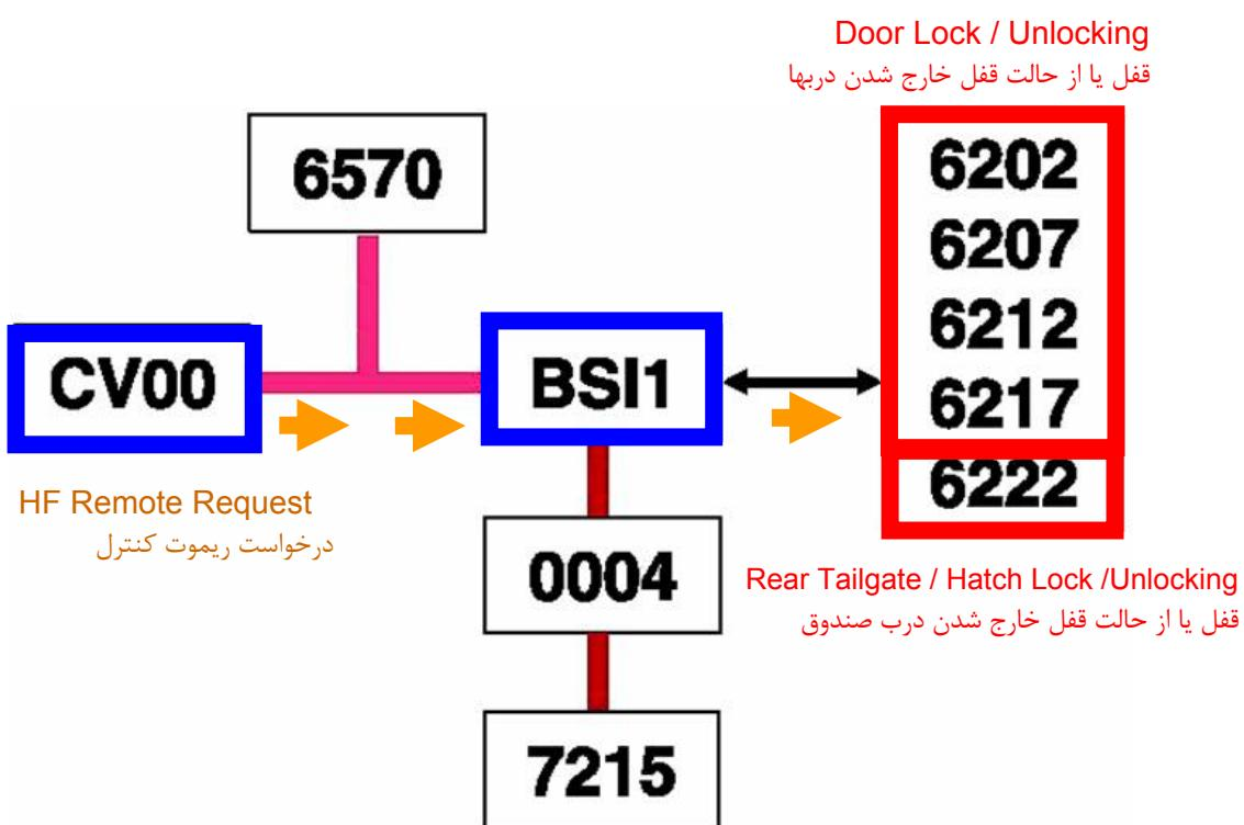
در صورت فشرده شدن یکی از دگمه های موجود روی کلید ریموت کنترل خودرو، CV00 سیگنال دریلفتی را از طریق شبکه BSI در اختیار VAN قرار داده و فرمان قفل شدن و یا از حالت قفل خارج شدن دربها را صادر می نماید .
