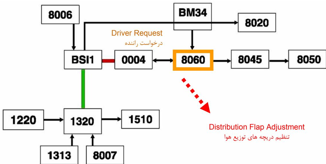
راننده با تغییر وضعیت سلکتور جهت وزش باد موجود روی پنل ، می تواند به صورت مکانیکی دریچه های موجود را باز و بسته نماید تا وزش باد را مطابق دلخواه تنظیم نماید .
