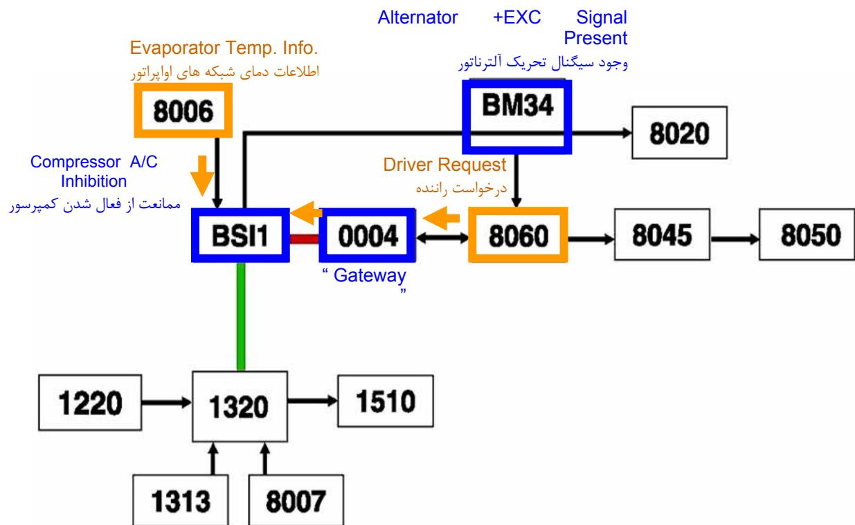
در صورت وجود سیگنال تحریک آلترناتور و درخواست راننده مبنی بر فعال شدن سیستم ، درخواست در صورت وجود سیگنال تحریک آلترناتور و درخواست راننده مبنی بر فعال شدن سیستم ، درخواست مورد نظر از پنل کولر- بخاری برای پشت آمپر ارسال می گردد تا از طریق شبکه VAN در اختیار BSI قرار گیرد . BSI به منظور جلوگیری از یخ زدگی شبکه های اوپراتور، اطلاعات سنسور اوپراتور را دریافت نموده و در صورتیکه اطلاعات دریافتی حاکی از دمای کمتر یا مساوی صفر درجه باشد ، BSI از کلچ کردن کمپرسور ممانعت به عمل خواهد آورد .
