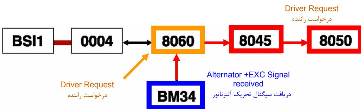
راننده با استفاده از سلکتور موجود روی پنل ، سرعت وزش باد را تنظیم می نماید . پنل گرمایش - تهویه در صورت دریافت سیگнал تحریک آلترناتور از BM34 به کمک مدول مربوطه کنترل دور موتور فن تهویه را انجام می دهد .
