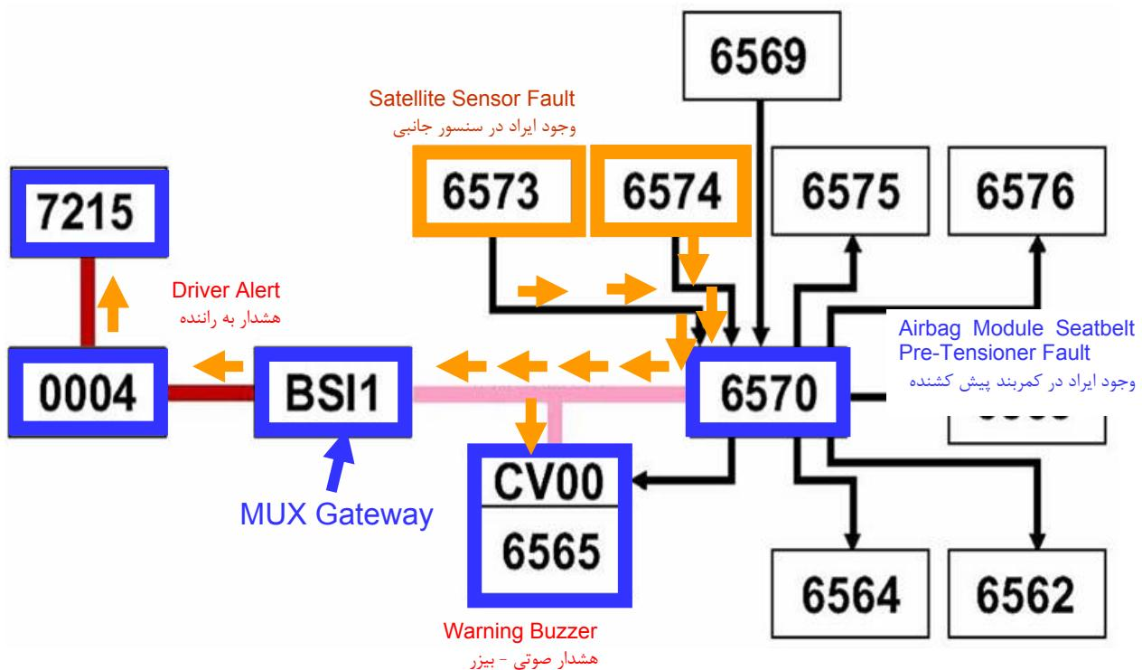
در صورت تشخیص وجود ایراد در کمربندهای پیش کشند و یا سنسورهای تشخیص ضربه جانبی توسط کنترل یونیت ایربگ ، مراتب به **CV00** جهت فعال کردن هشدار صوتی ، همچنین به **BSI** جهت ارسال درخواست نمایش ایراد مذکور روی نمایشگر چند منظوره از طریق پشت آمپر گزارش می گردد .
