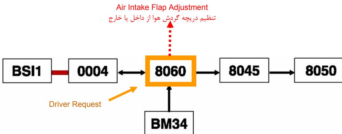
راننده با تغییر وضعیت کلید مربوطه ، به صورت مکانیکی موقعیت دریچه گردش هوا از داخل و یا خارج از اتاق سرنشین را تعیین می نماید.
