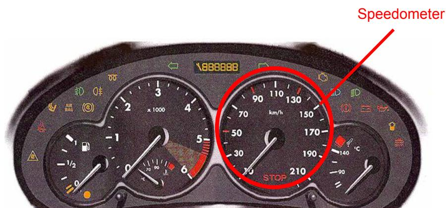
در صورت افزایش سرعت به بیشتر از ۲۰۰ کیلومتر بر ساعت ، BSI درخواست اعلام هشدار ممتد صوتی را به COM2000 فراهم می سازد و همچنین کاهش سرعت به زیر سرعت ۲۰۰ کیلومتر بر ساعت باعث قطع شدن هشدار صوتی بیزد می شود . البته می توان با استفاده از دستگاههای عیب یاب این سرعت را مشخص ساخت .
