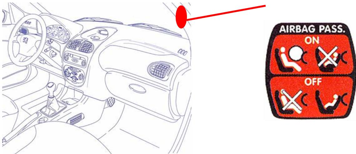
در صورت فعال کردن سوییچ ایربگ سمت شاگرد، کنترل یونیت ایربگ هرگز فرمان آتش شدن ایربگ سمت شاگرد را صادر نخواهد کرد. در این صورت یک علامت هشدار روی پشت آمپر و یک پیغام روی نمایشگر چند منظوره جهت اطلاع به راننده از غیرفعال شدن این سیستم نمایان خواهد شد.
