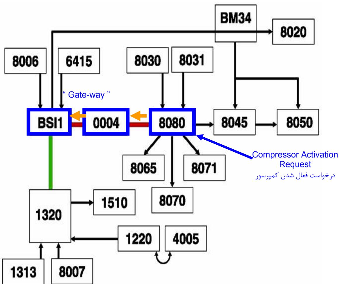
در حالت تنظیم دما به صورت دستی، راننده می‌تواند دگمه A/C را فشرده و درخواست فعال شدن کمپرسور را ارسال نماید.
