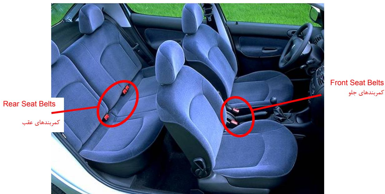
بسته به مشخصات خودرو ممکن است سوییچهایی در زیر قفل کمربند وجود داشته باشد که پس از حرکت خودرو و انتقال اطلاعات آن از طریق شبکه CAN به BSI، کنترل یونیت ایربگ و کمربندهای ایمنی VAN Body بیش کشندۀ درخواست روشن شدن LED مربوطه روی پشت آمپر را برای BSI از طریق شبکه ارسال نماید.
