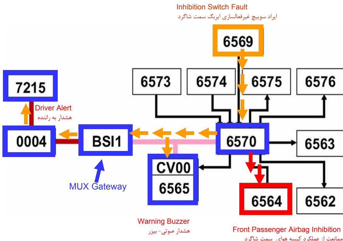
در صورت تشخیص وجود ایراد در سوییچ غیر فعال کردن ایربگ سمت شاگرد توسط کنترل یونیت ایربگ، از عملکرد کیسه هوای سمت شاگرد تدسته کنترل یونیت ایربگ ممانعت به عمل آمده و مراتب به **CV00** جهت فعال کردن هشدار صوتی، همچنین به **BSI** جهت ارسال درخواست نمایش ایراد مذکور روی نمایشگر چند منظوره از طریق پشت آمپر گزارش می گردد.
