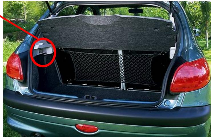
با باز و بسته شدن درب صندوق عقب این چراغ روشن و خاموش میگردد . باز و بسته شدن درب صندوق به کمک سوییج خاص نصب شده روی درب صندوق امکانپذیر می باشد .
