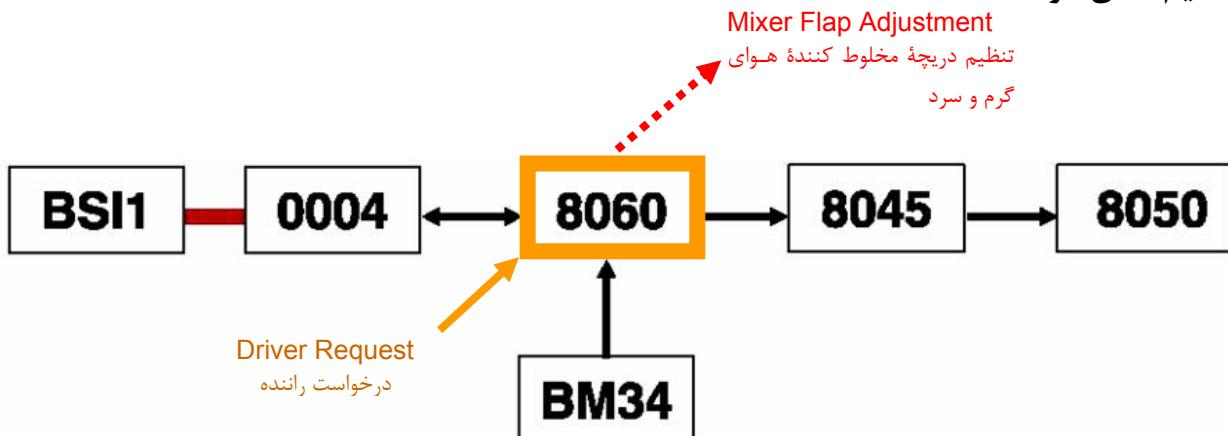
راننده با استفاده از دگمه مربوطه روی پنل گرمایش - تهویه ، دمای مورد نظر خود(میزان گرمی یا سردی) را به سیستم اطلاع داده و کنترل یونیت گرمایش - تهویه با تغییر مسیر هوا، گرم و سرد بودن هوای دمیده شده به داخل اتاق را مطابق درخواست راننده تنظیم می نماید .
