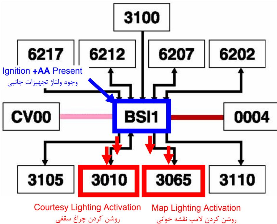
راننده درخواست خودرو را از طریق مجموعه کلید و چراغ سقفی برای BSI ارسال نموده و سپس در صورت وجود ولتاژ تجهیزات جانبی اقدام به روشن کردن چراغ مورد نظر راننده می نماید.
