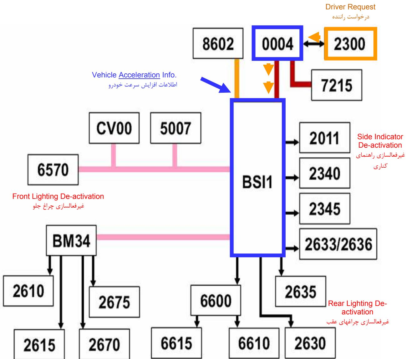
در صورت فعال شدن فلاشرها به یکی از دلایل وجود ضربه و یا کاهش سرعت قابل ملاحظه ، غیرفعال شدن فلاشر از طریق کلید فلاشر روی کنسول وسط به درخواست راننده و یا با افزایش مجدد سرعت امکانپذیر می باشد .
