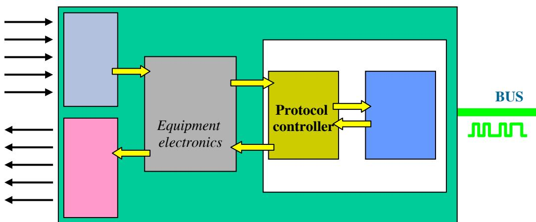
در این ساختار وظیفه Equipment Electronics دریافت اطلاعات سنسورها پس از تبدیل به حالت دیجیتال و پردازش آنها می باشد . سپس ارسال اطلاعات به مبدل‌های دیجیتال به آنالوگ تابه عملگرها برستند . وظیفه Protocol Controller فرم دادن به اطلاعات دریافتی از Equipment Electronics به گونه ایکه قابل انتقال روی شبکه باشد و به همین ترتیب عکس این عمل یعنی دریافت اطلاعات از فریم دریافتی از شبکه و تبدیل آن به صورتیکه توسط Equipment Electronics قابل پردازش باشد .
