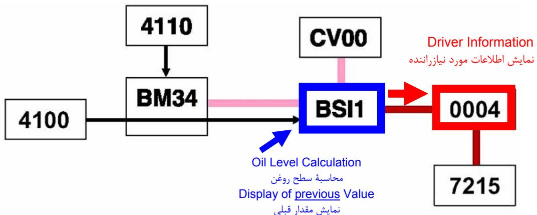
پس از دریافت اطلاعات مربوط به دما و میزان روغن موتور به صورت مستقیم از سنسور مربوطه و دریافت ولتاژ تغذیه سوییچ باز ، اقدام به انجام محاسبات لازم نموده و سپس اطلاعات راجهت نمایش روی پشت آمپر ارسال می نماید . BSI ، تا قبل از باز شدن سوییچ خودرو و یا در صورت عدم دریافت اطلاعات از سنسور دما و میزان روغن موتور، درخواست نمایش مقادیر قبلی را صادر می نماید .
